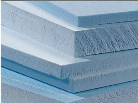
Exemplo de placas de poliestireno expandido extrudido (<http://isolotrofa.com/isolamentos/dw-imp03-3/>)
