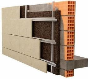
Esquema de fachada ventilada com isolamento térmico aderente à face exterior da parede e placa de revestimento cerâmico aplicada em estrutura intermédia
