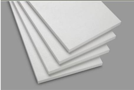
Exemplo de placas de poliestireno expandido moldado (<https://www.tecnovite.pt/eps/eps-na-construcao/>)
