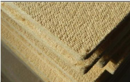
Placas de isolamento térmico em fibras de madeira expandida
