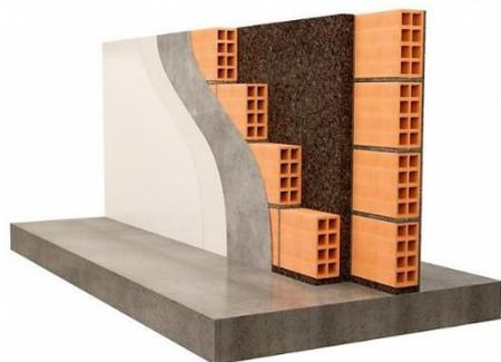
Esquema de parede de pano duplo com isolamento acústico (<https://www.amorimcorkinsulation.com/>)
