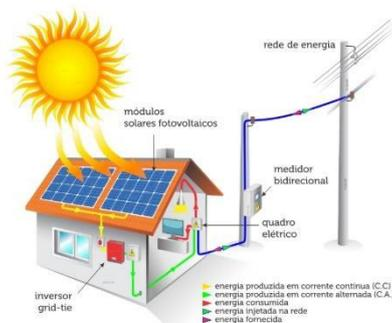
Esquema de sistema fotovoltaico (Adaptado de <https://museuweg.net/blog/o-que-e-e-como-funciona-a-energia-solar-fotovoltaica/>)
